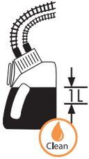
7. Verser le reste de la solution dans le crachoir.
