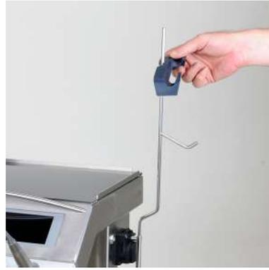
Positionner et fixer le support du moteur.
