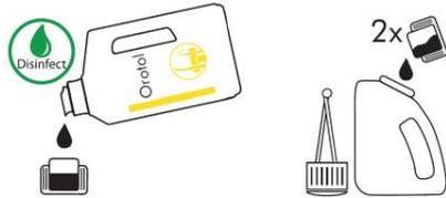
Remplissez l'OroCup avec de l'eau froide jusqu'à 2 litres. Fermez l'OroCup et mélangez la solution.
